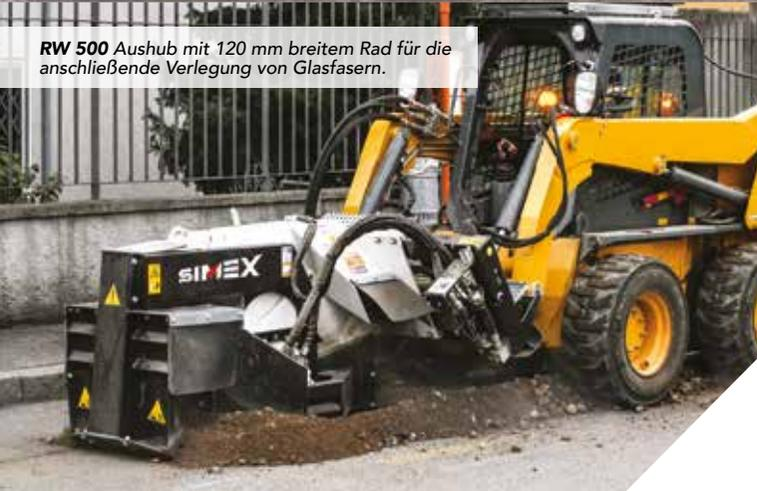
**RW 500** Aushub mit 120 mm breitem Rad für die anschließende Verlegung von Glasfasern.
