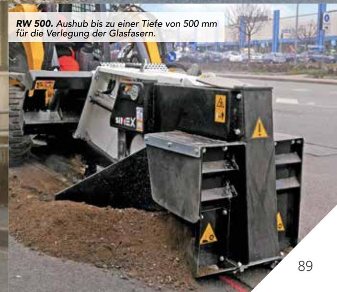
**RW 500.** Aushub bis zu einer Tiefe von 500 mm für die Verlegung der Glasfasern.
