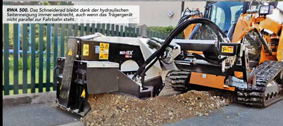
**RWA 500.** Das Schneiderad bleibt dank der hydraulischen Seitenneigung immer senkrecht, auch wenn das Trägergerät nicht parallel zur Fahrbahn steht.
